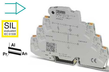
Circuito de dos hilos (loop), sin potencial de tierra, conexión 3/6 con puesta a tierra directa, p. ej. para bucles de corriente de 4 ... 20 mA
