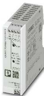
Fuente de alimentación, 1 AC, 24 V DC, 2.5 A, SC NEC clase 2
