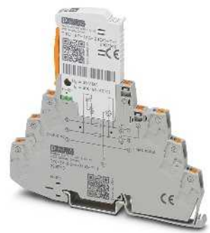
Circuito de dos hilos (loop), sin potencial de tierra, conexión 3/6 con puesta a tierra directa, con interrupción por cuchilla, p. ej. para bucles de corriente de 4 ... 20 mA
